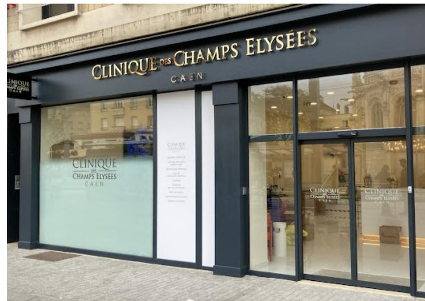
La première enseigne est conçue en tôle d'aluminium laquée, avec des lettres découpées en PMMA de 6 mm d'épaisseur en acier inoxydable poli miroir doré et équipées de LED. En ce qui concerne la seconde, les lettres sont fabriquées en laiton, avec une finition polie miroir de 30 mm d'épaisseur, et sont rétroéclairées par des LED.
